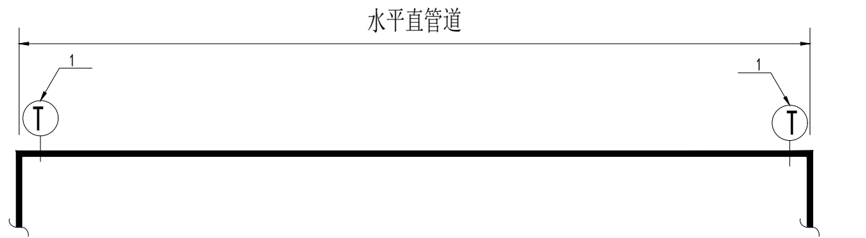
图1 水平直管段抗震支吊架设置 1—抗震支吊架
